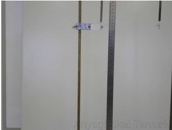
2.ábra. Terheletlen rugó helyzetének beállítása.
