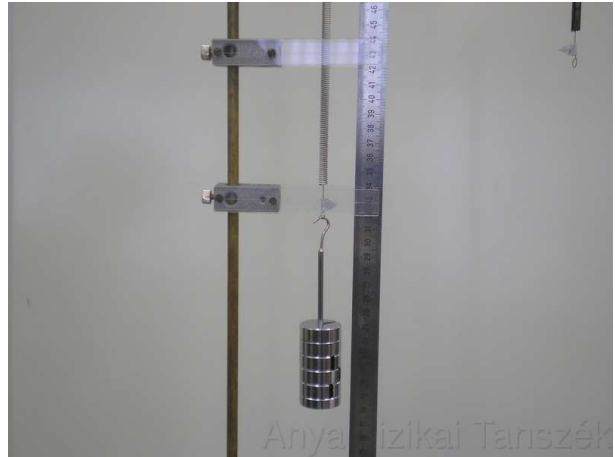
3.ábra. Terhelt rugó helyzetének beállítása.
